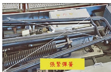
圖 9 集電弓上舉力與張緊彈簧示意圖
