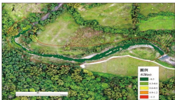
圖 4 水深分布圖 (施工前)
