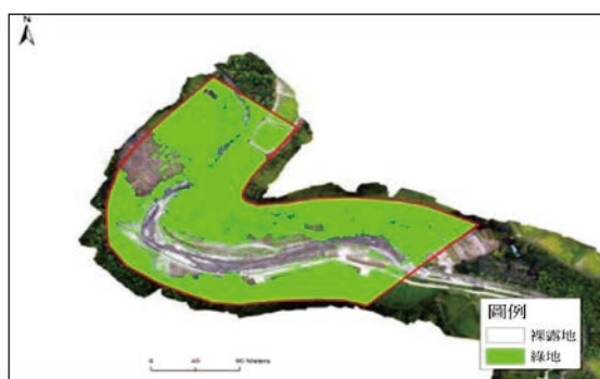
圖 15 綠覆率 VARI 判釋圖 (完工後)
