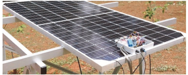
圖 3 本研究設計之監測盒（為拍照置於板上方，實際黏著板下方）
