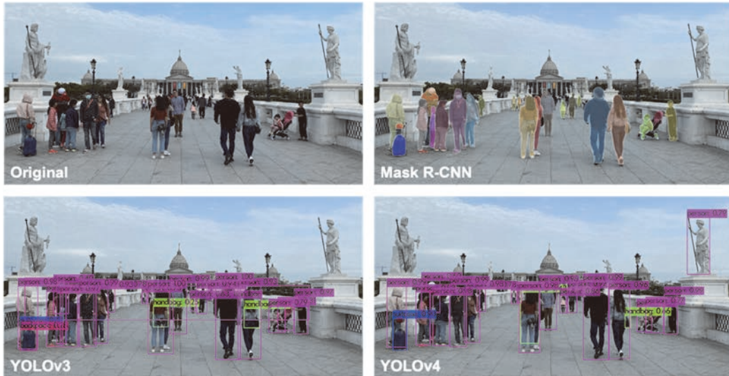
圖 2 左上角為原始圖片；右上為使用 Mask R-CNN 偵測結果；左下為 YOLOv3 偵測結果；右下為 YOLOv4 偵測結果。拍攝於臺南奇美博物館
