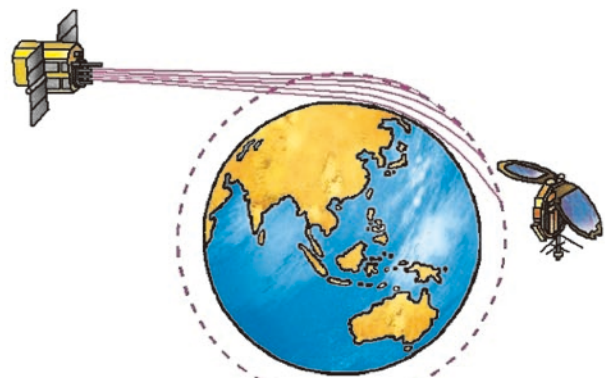
圖 4 掩星技術示意圖 (圖片來源: 國家太空中心)
