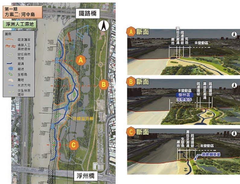
圖 4 河中島方案平面及剖面示意圖 資料來源：經濟部水利署第十河川局 [4]
