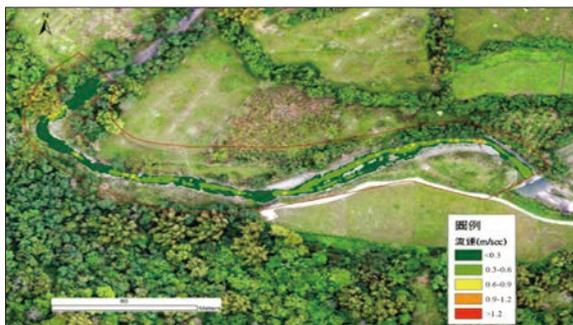
圖 5 流速分布圖 (施工前)
