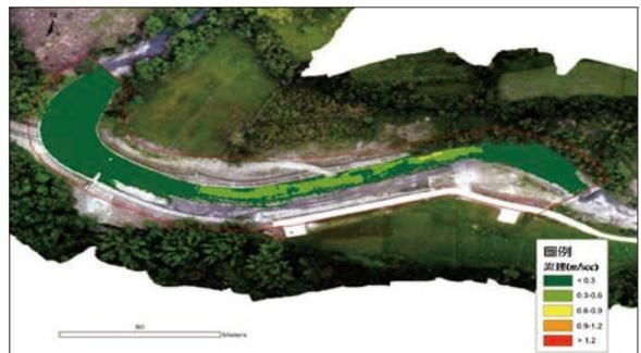
圖 9 流速分布圖 (完工後)
