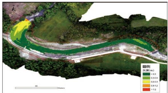
圖 8 水深分布圖 (完工後)
