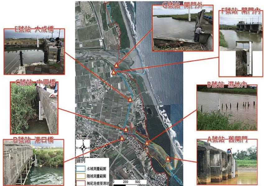
圖 4 無尾港濕地自記式水位計及水尺佈置圖。各點位係參考濕地水系、流況進行佈置，優先設置點位包含：濕地水系上、下游邊界、濕地內其他入流邊界及閘門上下游等可透過人為操作影響水位之水利設施；此外，儀器架設時需選擇於流況及斷面型態較穩定處<sup>[2]</sup>。
