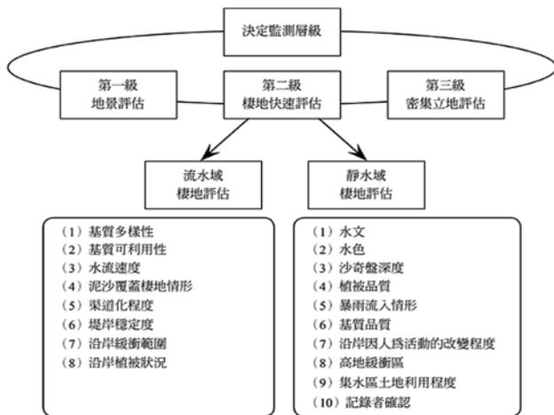
圖 7 濕地棲地快速評估流程<sup>[5]</sup>
