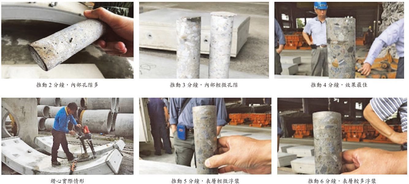
圖 4 環片中間及兩端鑽心觀察混凝土內部振動搗實情形
