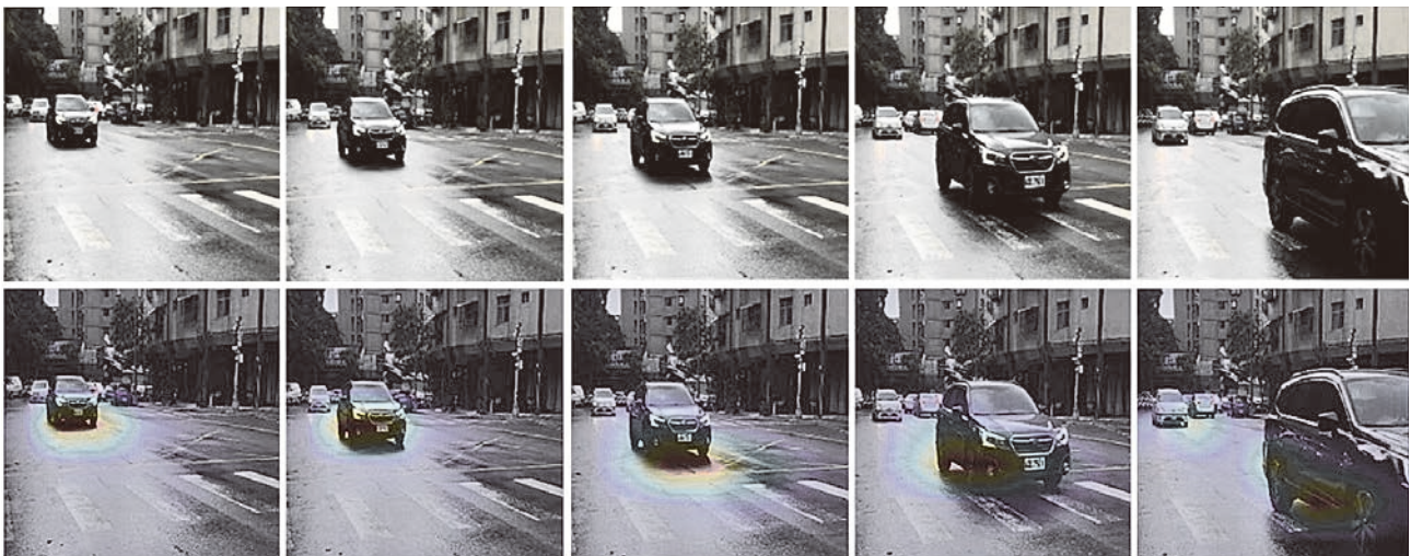
圖 5 低能見度環境之車輛偵測結果 (2020/9/13 午，雨天)
