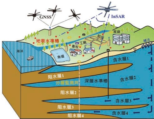
圖 1 台灣地層下陷多元化監測系統
