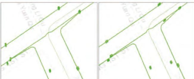
圖 5、人手孔旋轉角修正 3D 呈現 (左為原始圖, 右為修正後)
