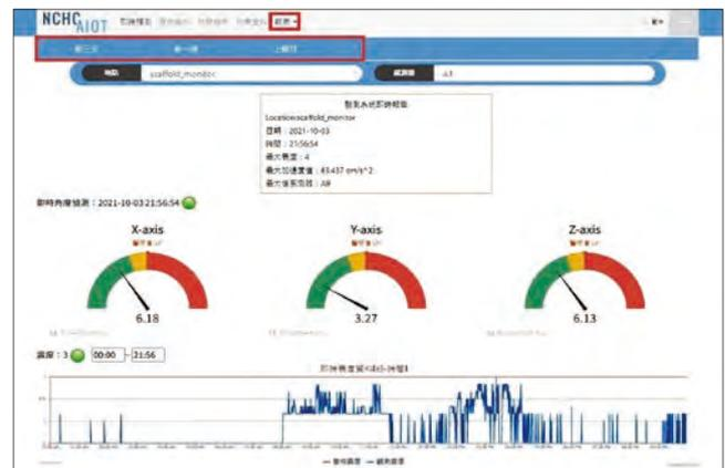
圖 33 「施工架智能監控系統」數據報表功能
