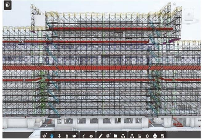
圖 9 施工架 BIM 模型建置圖
