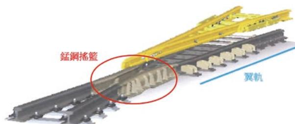
圖 6 可動式岔心搖籃及翼軌區域示意
