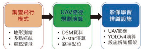
圖 1 自動化 UAV 巡檢測繪規劃及港區構造物偵測分析研究方法流程圖
