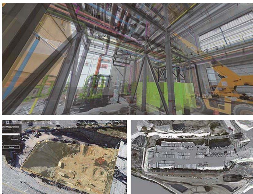
圖 3 應用影像進行進度、品質管控，也可利用影像重建點雲製作高解析度正射投影圖進行土方量測、動線規劃、等高線比對。
