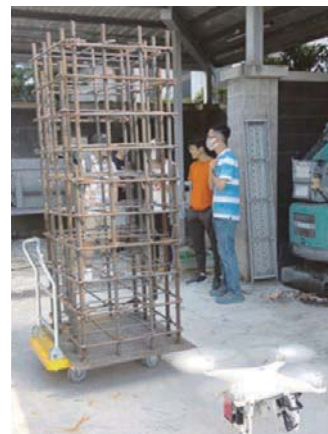
(b) 無人飛行載具執行鋼筋查驗實驗的側拍影像
