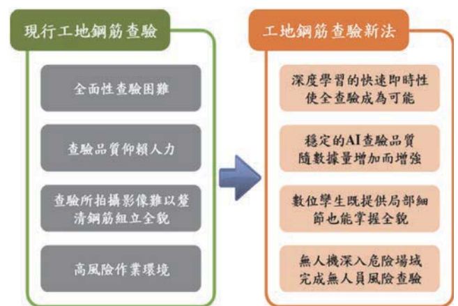
圖 2 現行工地鋼筋查驗與本研究所提出的工地鋼筋查驗新法的比較
