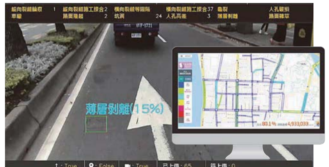
圖 14 即時拍攝影像辨識道路鋪面破損類型，並且登錄於 GIS 圖台中顯示路網各處之道路鋪面 PCI 指標（台北市政府工務局提供）
