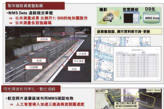
圖 17 日本利用 MMS 產製 1/500 比例尺地圖利於道路資產盤點與管理
