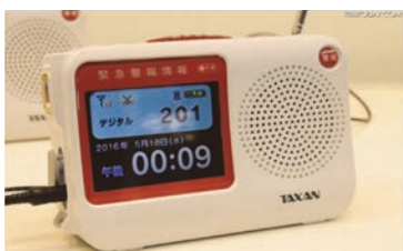
圖 7 結合電子日曆時鐘及收音機功能之地震警報裝置 (引用自 https://www.rbbtoday.com )
