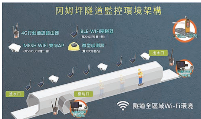
圖 1 阿姆坪隧道 IoT 物聯網監控環境架構
