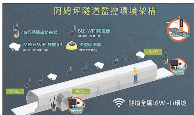
圖 1 阿姆坪隧道 IoT 物聯網監控環境架構
