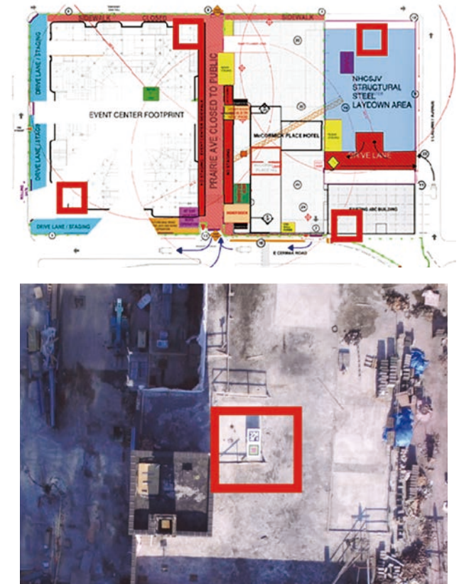
圖 7 應用 QR Code 方式自動對應 BIM 模型及點雲模型
