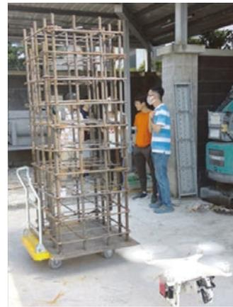
(b) 無人飛行載具執行鋼筋查驗實驗的側拍影像
