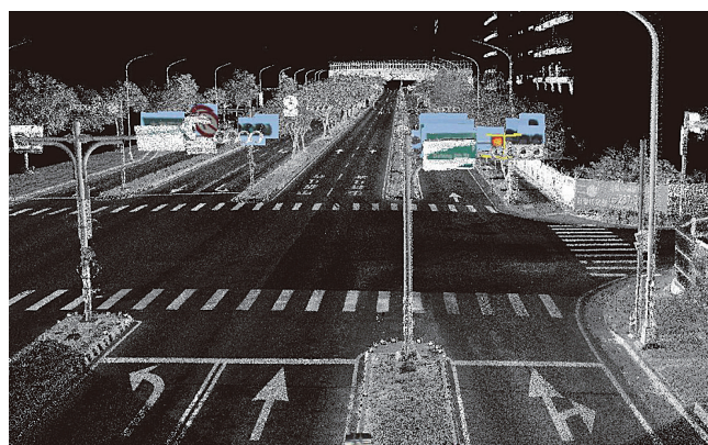
圖 13 環景影像物件經 AI 辨識後再經過攝影測量計算與物空間匹配結果
