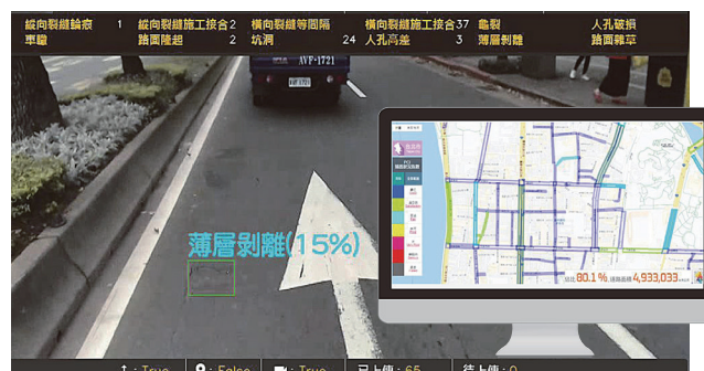
圖 14 即時拍攝影像辨識道路鋪面破損類型，並且登錄於 GIS 圖台中顯示路網各處之道路鋪面 PCI 指標（台北市政府工務局提供）
