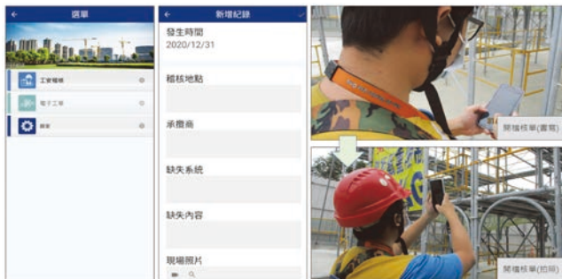
圖 20 工地巡檢器開立缺失
