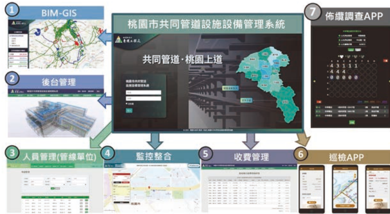
圖 4 桃園市共同管道設施設備管理系統介面
