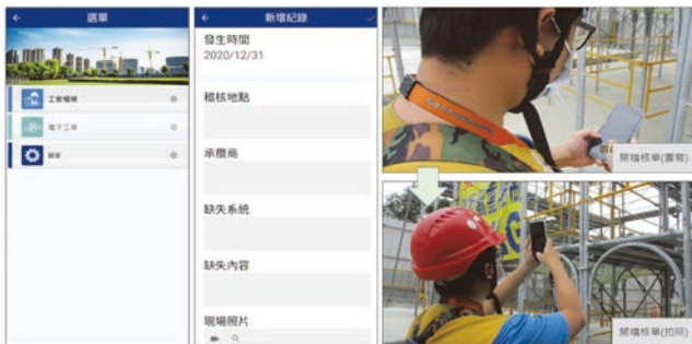
圖 20 工地巡檢器開立缺失
