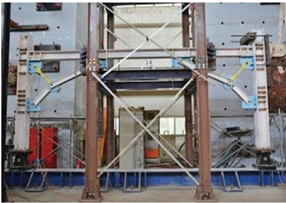
圖 6 外側配置消能元件 Y 型隅撐構架
