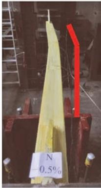
圖 4 UR-89 斜撐試體 整體挫屈情形
