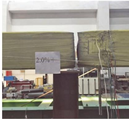
圖 5 UR-89 斜撐試體斷裂情形
