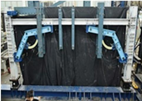
圖 11 內側配置消能元件 Y 型隅撐構架
