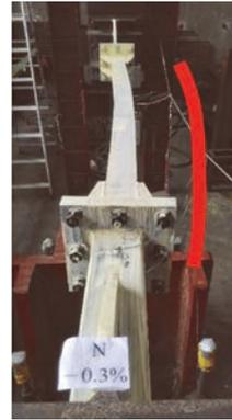
圖 6 LU-89 斜撐試體 整體挫屈情形
