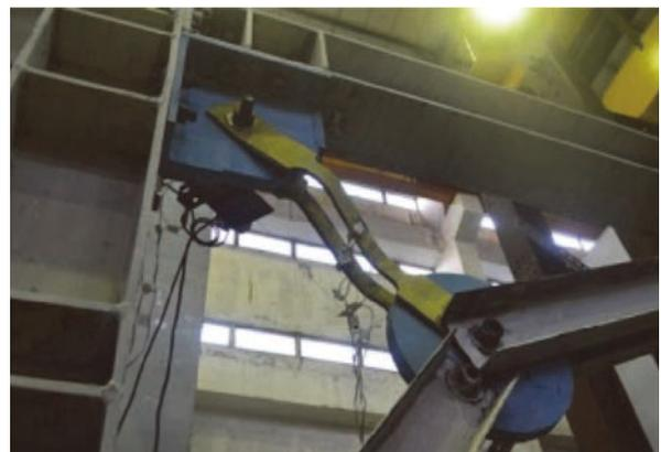
圖 10 Y 型隅撐構架之消能鋼板挫屈模式
