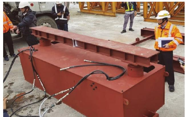
圖 8 支撐架頂部垂直及縱向移動機構
