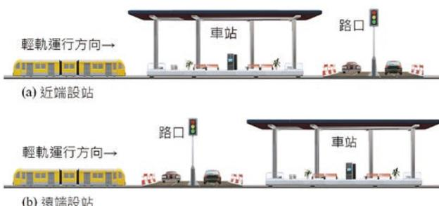
圖 5 近端與遠端設站示意圖
