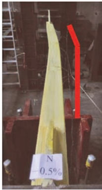
圖 4 UR-89 斜撐試體 整體挫屈情形
