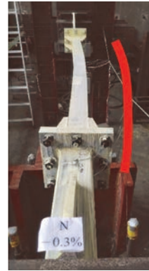
圖 6 LU-89 斜撐試體 整體挫屈情形
