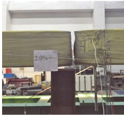
圖 5 UR-89 斜撐試體斷裂情形
