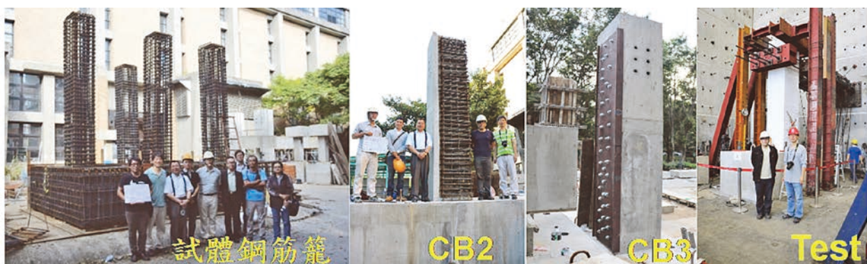
圖 4 鋼筋混凝土連梁剪力補強之試體製作過程
