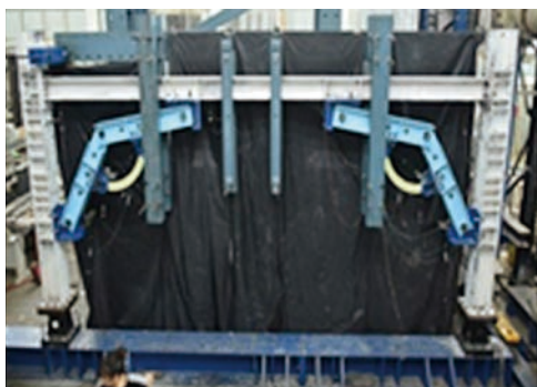
圖 11 內側配置消能元件 Y 型隅撐構架
