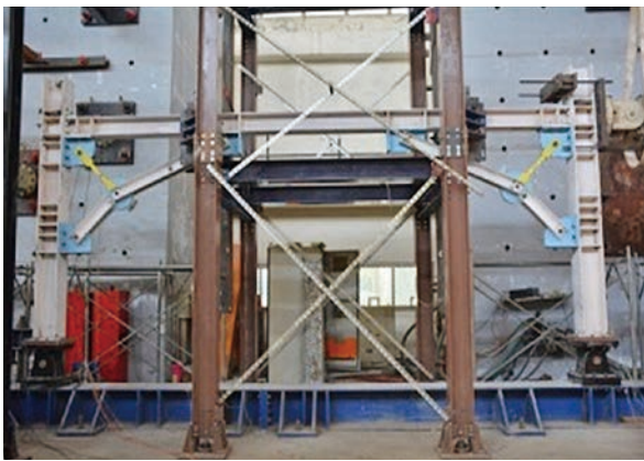
圖 6 外側配置消能元件 Y 型隅撐構架
