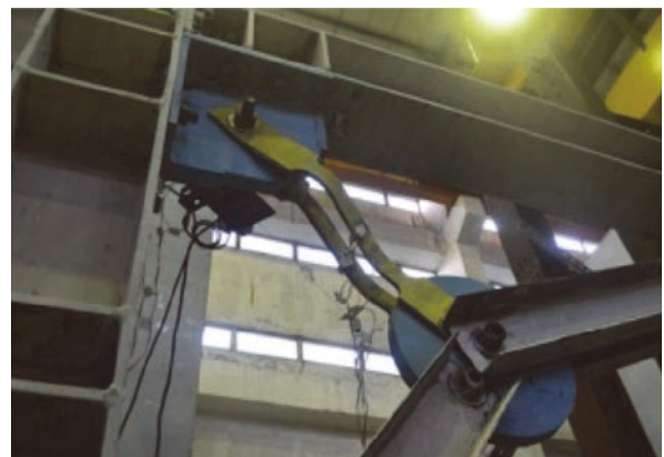
圖 10 Y 型隅撐構架之消能鋼板挫屈模式
