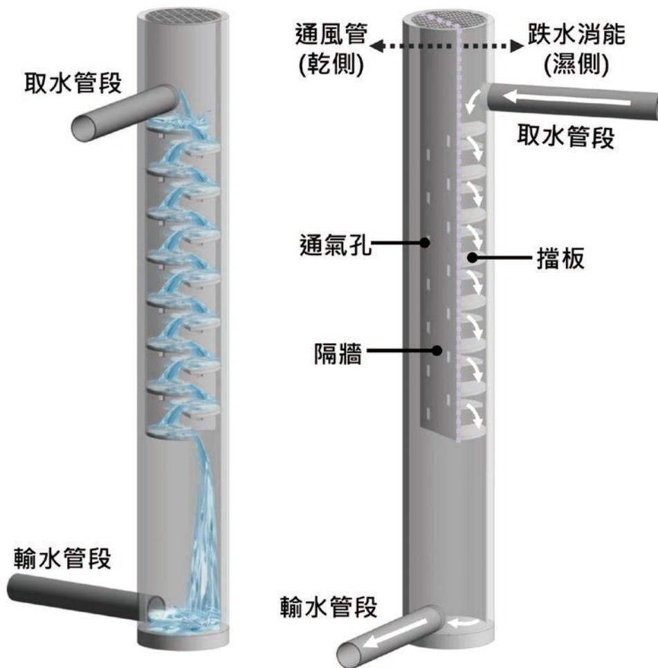
**結構** 直徑 $\phi$ 7.6m，深63m，擋板15階的鋼筋混凝土
