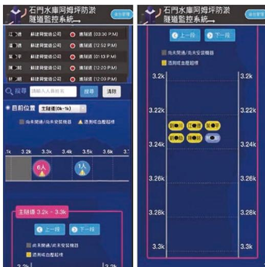
圖 13 以手機監控隧道內人員狀況
