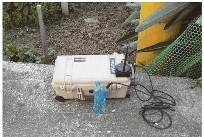
圖 6 簡易式觀測站進行無線土壤含水量計改裝作業
