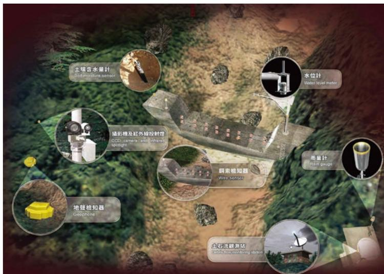
圖 1 固定式土石流觀測站硬體配置圖
