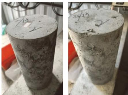
熱壓膨脹試驗前 熱壓膨脹試驗後
