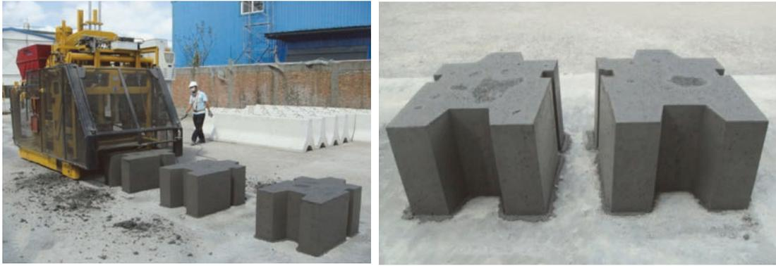
圖 10 實廠壓製之爐石 / 飛灰基無機聚合爐石類副產物混凝土人形砌塊
