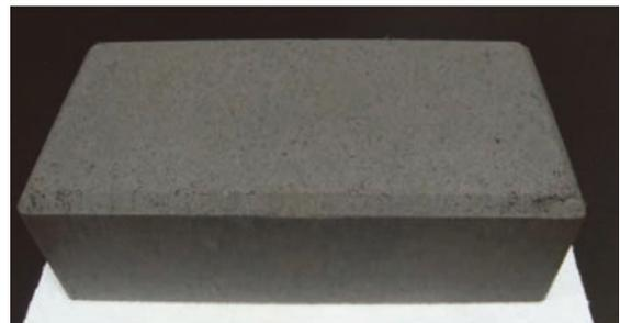
圖 3 冷壓型無機聚合轉爐石高壓地磚試壓結果-2
