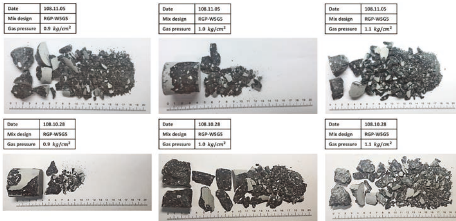
圖 15 RGP-W5G5 試體撞擊後破壞產狀
