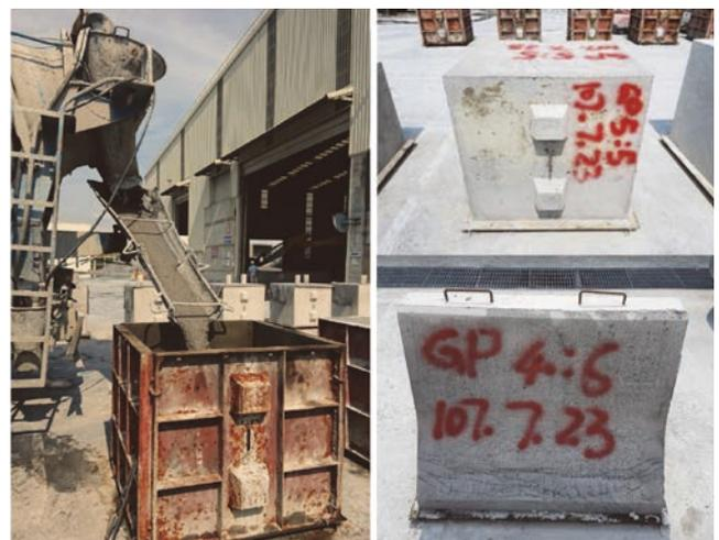
圖 8 預拌廠實廠廠拌並製成擋料塊及紐澤西護欄的情形
