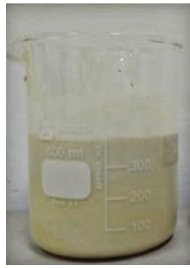
圖 6 底漆樹脂拌合後呈現膠狀
