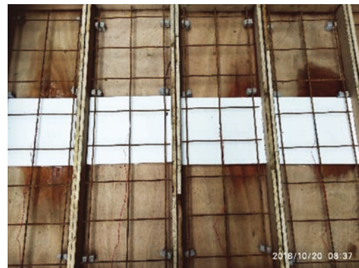
圖 5 矩形凹口試體組模完成照片
