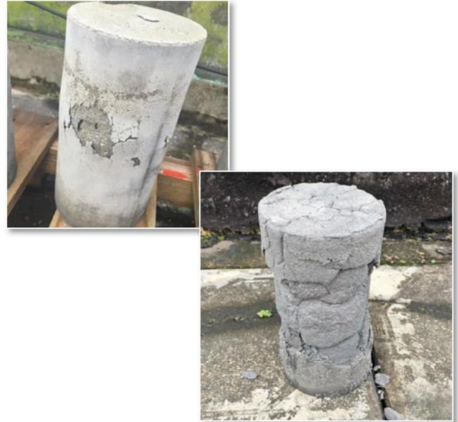
圖 7 未額外添加鋁的爐石 / 飛灰基無機聚合混凝土試體 ( $\phi 10 \times 20 \text{ cm}$ ) 放置室外環境經長時間被風化的情形
