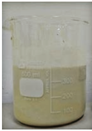
圖 6 底漆樹脂拌合後呈現膠狀
