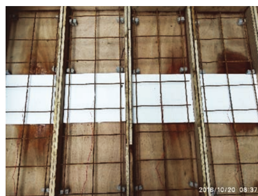
圖 5 矩形凹口試體組模完成照片
