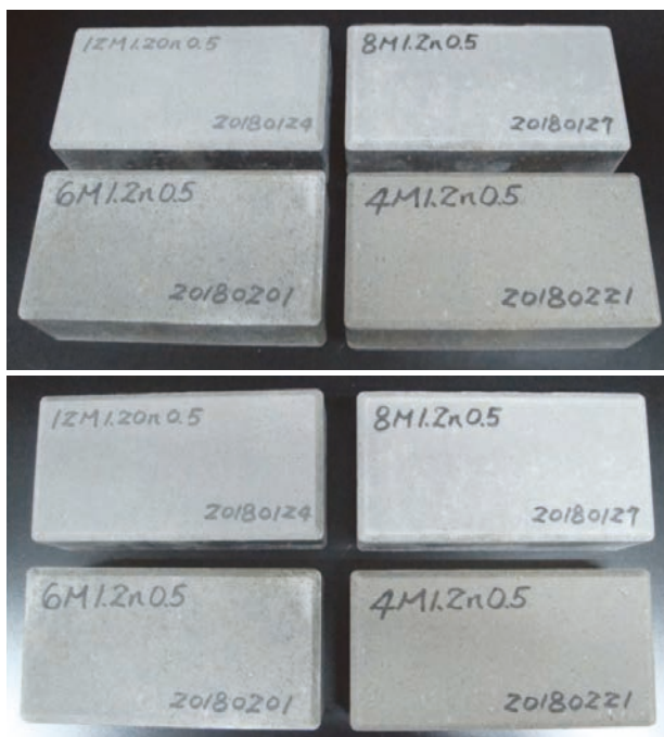
圖 4 不同鹼液濃度冷壓型無機聚合轉爐石高壓地磚成品
