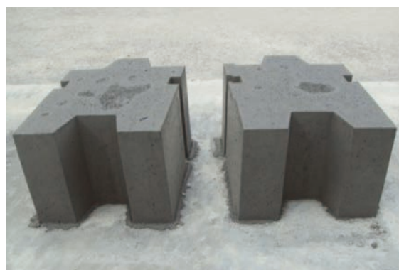
圖 10 實廠壓製之爐石 / 飛灰基無機聚合爐石類副產物混凝土人形砌塊
