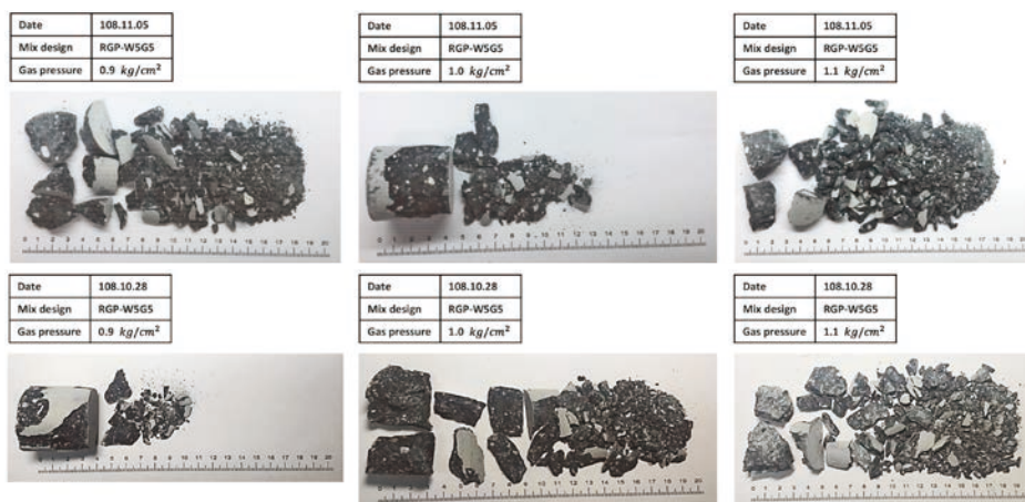
圖 15 RGP-W5G5 試體撞擊後破壞產狀
