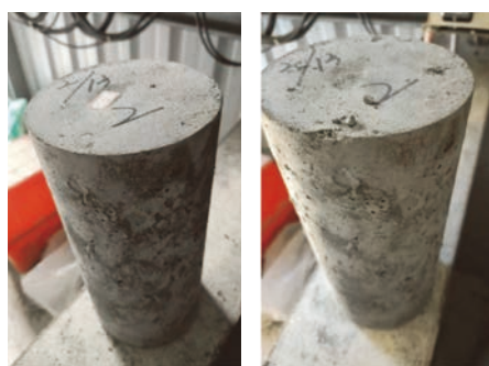
圖 11 實廠壓製之爐石 / 飛灰基無機聚合爐石類副產物混凝土熱壓膨脹試驗結果
