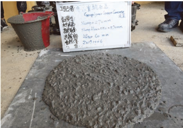
圖 1 無機聚合混凝土 45 分鐘後的工作性 (攝於 2017/10/6)
