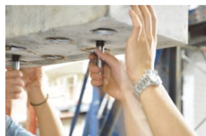
圖 6 MRCSK 單一節塊型式與 MSSK 分離式剪力樺
