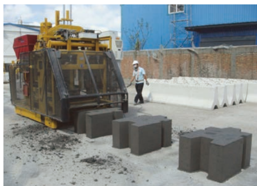
圖 10 實廠壓製之爐石 / 飛灰基無機聚合爐石類副產物混凝土人形砌塊
