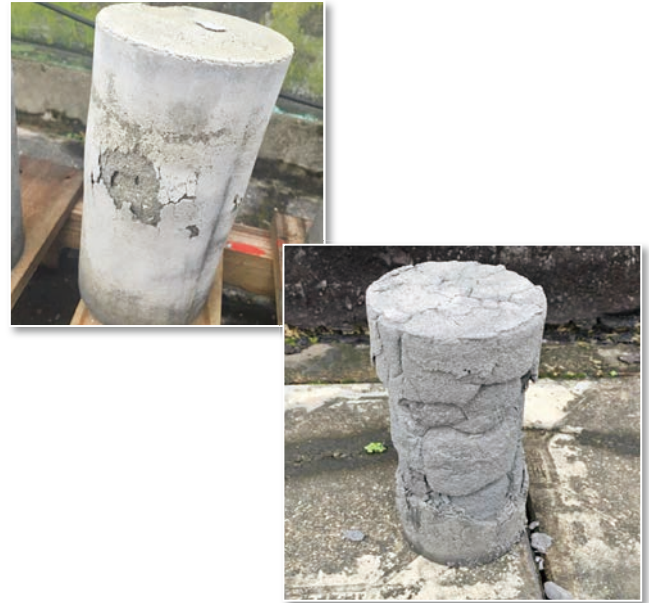
圖 7 未額外添加鋁的爐石／飛灰基無機聚合混凝土試體 ( \phi 10 \times 20 \text{ cm} ) 放置室外環境經長時間被風化的情形
