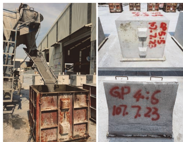
圖 8 預拌廠實廠廠拌並製成擋料塊及紐澤西護欄的情形
