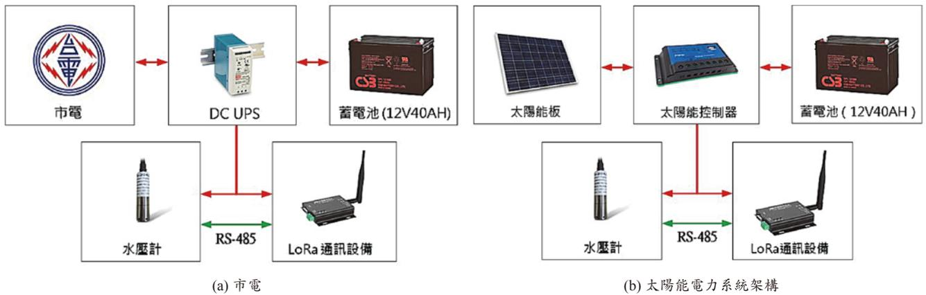
圖 11 前端水壓計及 LPWAN 通訊設備<sup>[4]</sup>
