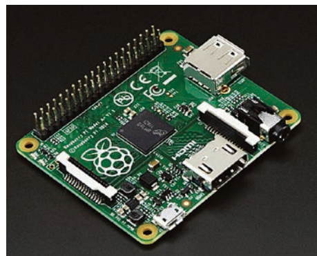
圖 4 樹莓派 Raspberry Pi 1 Model A+
