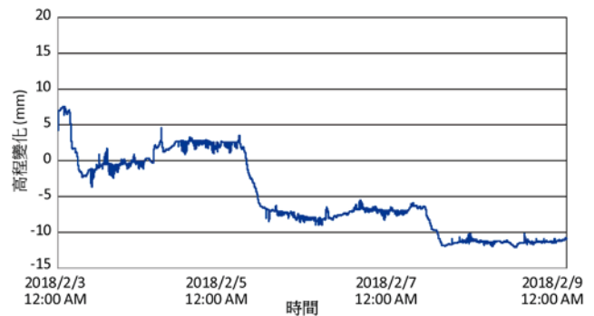
圖 12 以北港衛星追蹤站為參考站解算臺西衛星追蹤站高程變化成果
