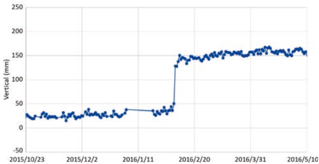
圖 5 中央研究院 GPS Lab 提供之 LNCH GPS 連續追蹤站美濃地震期間高程變化
