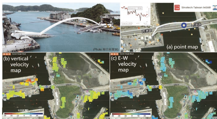
圖 10 長時序 InSAR 於橋梁監測（資訊平台：中興社；2019/2/4 ~ 2019/9/26）
