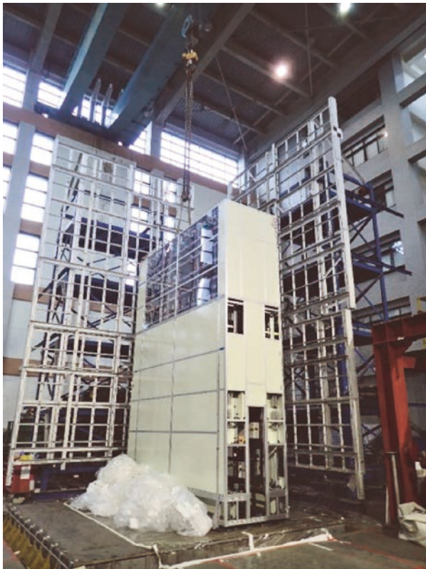
圖 16 在 NCREE 進行之半導體設備振動台測試
