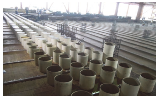
圖 14 洞洞板的圓桶模具
