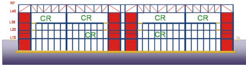
圖 1 半導體廠的剖面圖，紅的方塊是 RC 剪力牆
