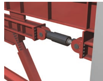
圖 13 半導體廠房阻尼器採水平方向配置
