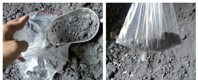
圖 10 鋼鐵爐渣取料情形
