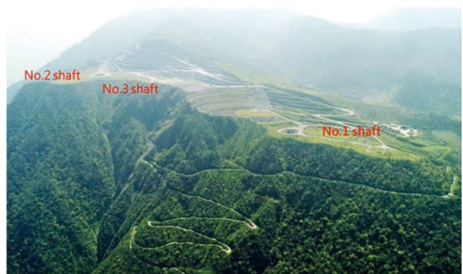
圖 2 山頂平臺式階段開採豎井運輸法
