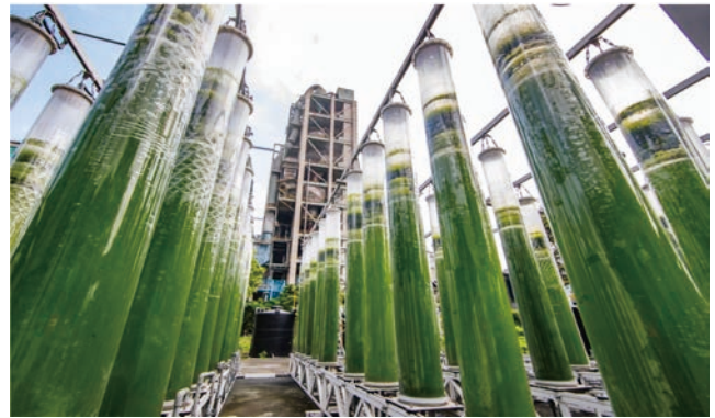
圖6 戶外微藻固碳系統
