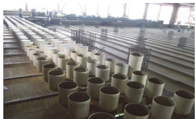
圖 14 洞洞板的圓桶模具
