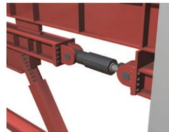
圖 13 半導體廠房阻尼器採水平方向配置
