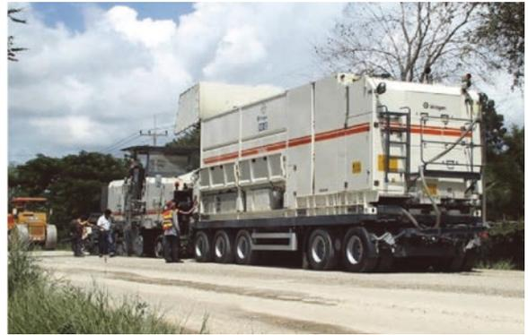
圖 3 濕式泵送方法及水泥稀漿設備
