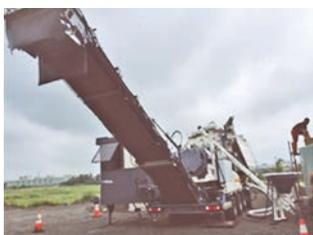
圖 8 發泡瀝青混凝土生產設備
