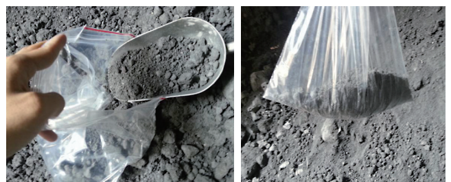
圖 10 鋼鐵爐渣取料情形
