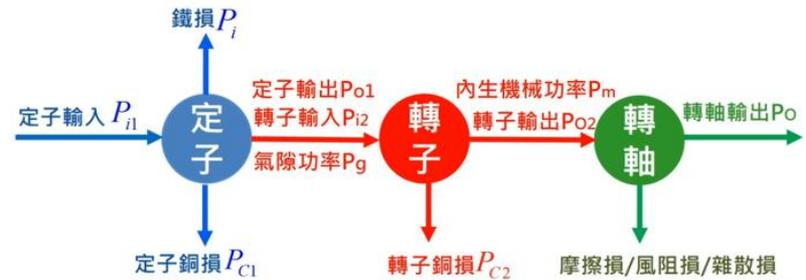
電動機能量損耗種類圖
