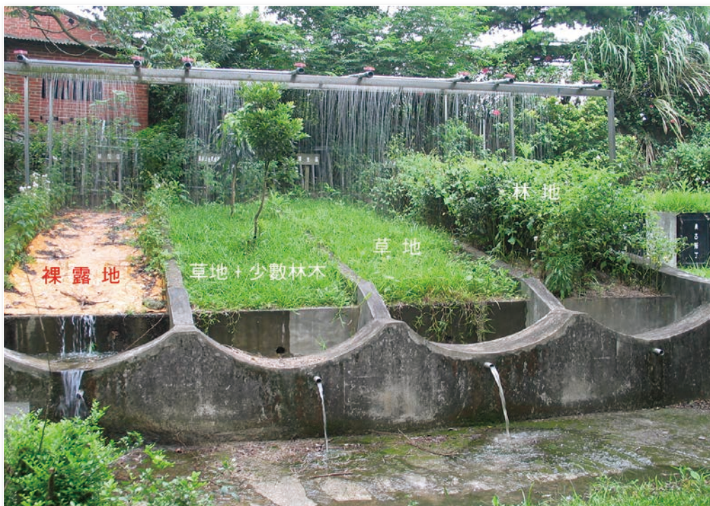
圖 1 在豪雨侵襲下，樹林保水能力最強 (台灣水土保持局野外模型實驗) (洪如江攝)
