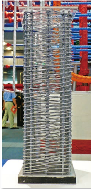
← 圖 36 鋼筋混凝土柱的螺旋箍筋將主筋嚴密圍束，在強烈地震時今固若金湯，尹衍樑教授發明（洪如江攝）
