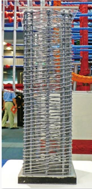
← 圖 36 鋼筋混凝土柱的螺旋箍筋將主筋嚴密圍束，在強烈地震時今固若金湯，尹衍樑教授發明（洪如江攝）
