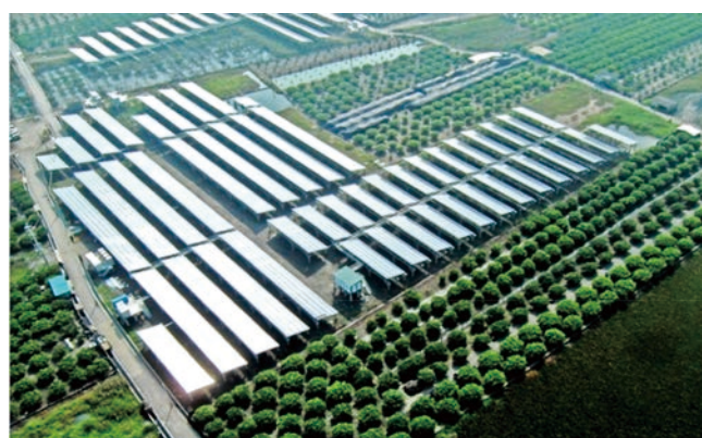
經濟部能源局補助，民間廠商投資，100 年 12 月完成太陽光電板設置計 43 公頃，101 年發電量計 2,849 萬度。
